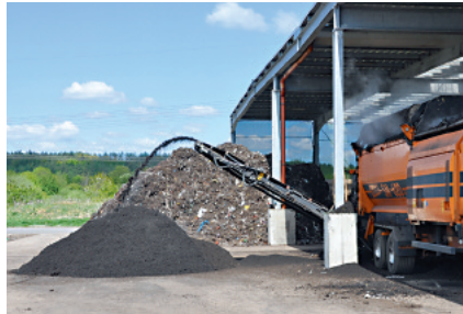
Nach Absiebung entsteht hochwertiger Kompost
